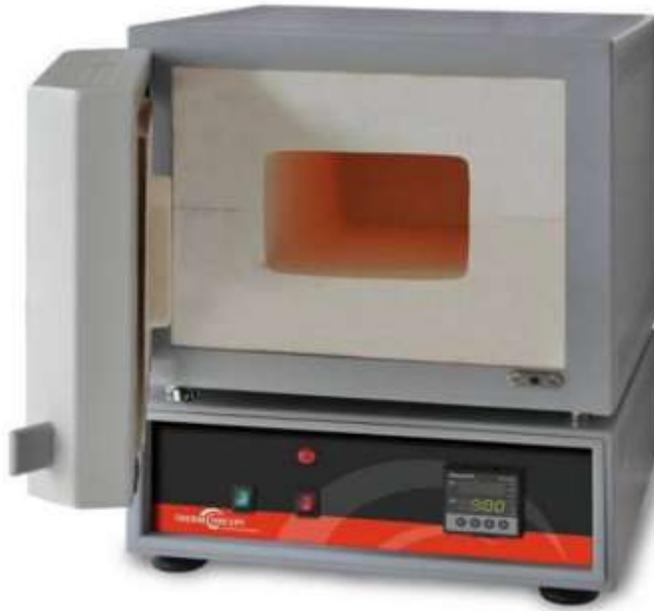
**Figura 26. Mufla para la obtención de cenizas**
